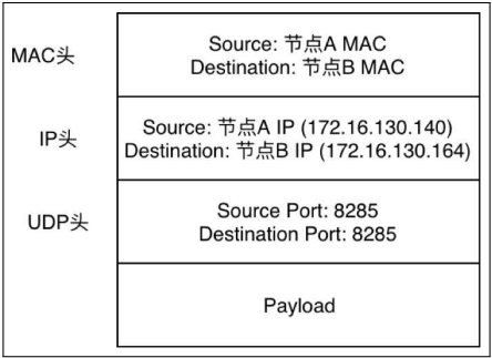
图 5-5 封包后的 ICMP 以太网帧格式
